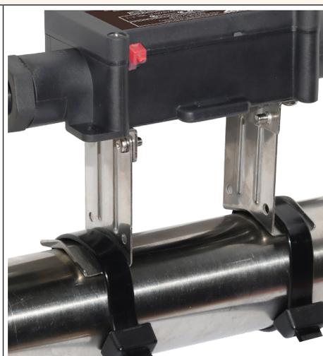
3: 一个不锈钢支架，用于在管道上的扩展安装，在绝缘材料及其保护层已安装后，允许外壳锁定。允许的绝缘厚度为 50mm，可用于热管。用尼龙扎带或金属夹子夹紧在金属或 PVC 管道上。(脚可作为附件使用。)
