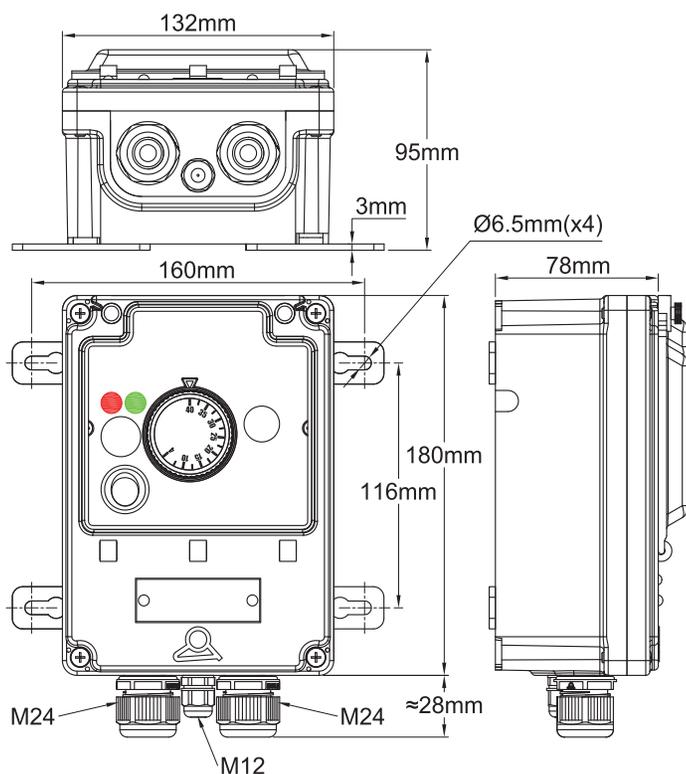
带 3 个电缆接头的型号 (2 × M24+1 × M12): Y8WR-X
