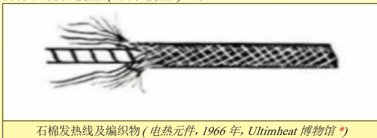
1977年8月，由于意识到石棉的危险，颁布了第一个关于接触石棉粉尘的工人的保护法令，随后，在1997年，法国全面禁止了使用石棉。结果，这些类型的发热元件从市场上消失了。
