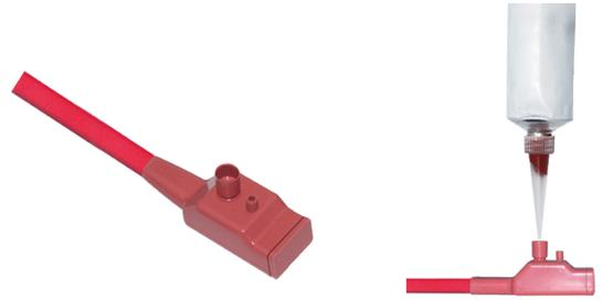
10: 将组件放置在一个水平的表面上，并通过填充漏斗用液态的室温硫化硅胶进行填充，直到该硅胶开始在小的排气开口中上升。让其静置固化约 24 小时。
