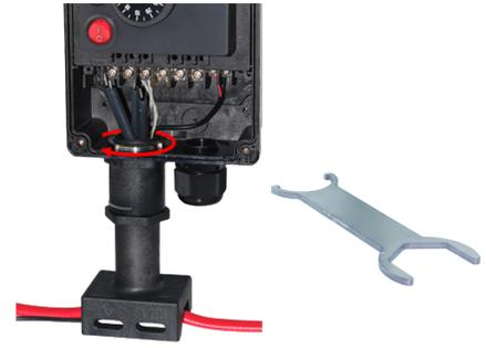
12: 将垫圈放置在脚部上方的凹槽中，将控制装置放在其上方。根据所需的位置调整外壳的方向，然后放置并拧紧带齿的螺母，直到其锁紧为止。
