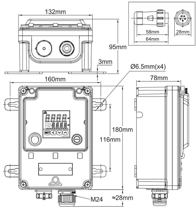
带 3 个电缆接头的型号 (2 × M24+1 × M12): Y8WJ-X
