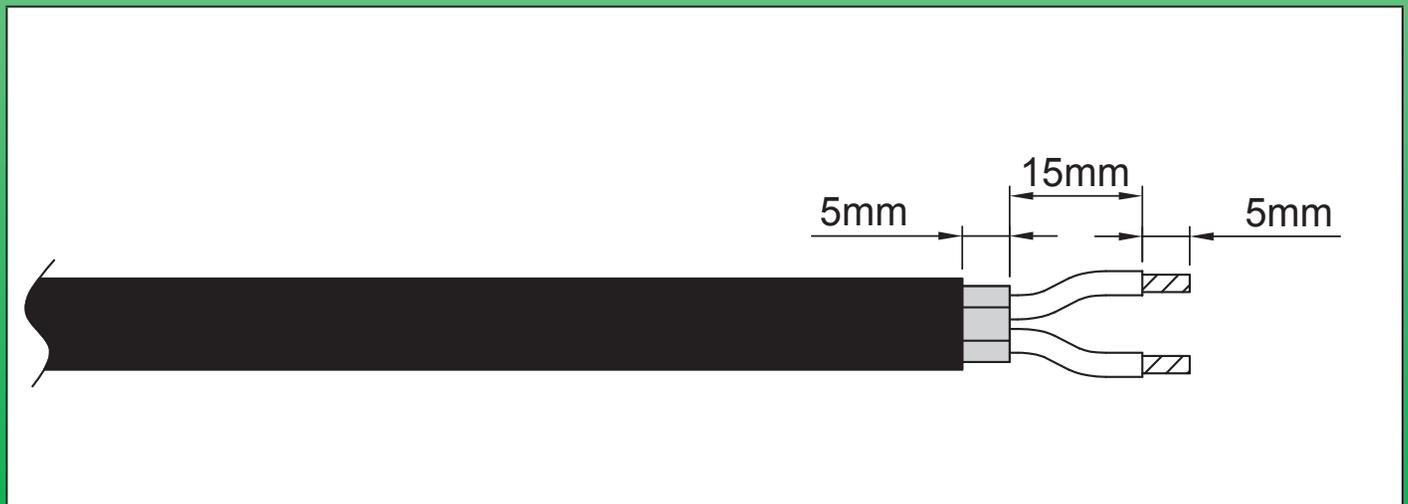
用于在**温控器的发热电缆和电源线连接**的硅胶套（现场或车间组装）。在发热电缆的自由端安装，用于椭圆形发热电缆，限于带**两条并排总线的串联**的型号。通过焊接进行连接。通过硅胶套 + 室温硫化进行密封连接。
