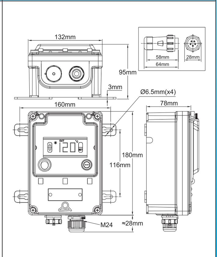
带 3 个电缆接头的型号 (2 × M24+1 × M12):
