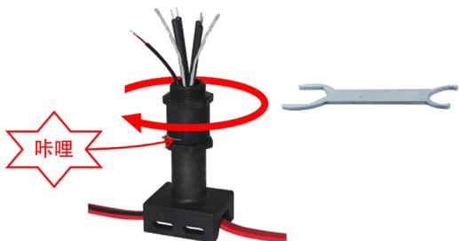
11: 通过拧紧支脚的上部配件进行压缩密封件。拧紧后，一个小卡簧会挡住该组件 (拆卸时，有必要卸下该小的半圆形的卡簧)。
