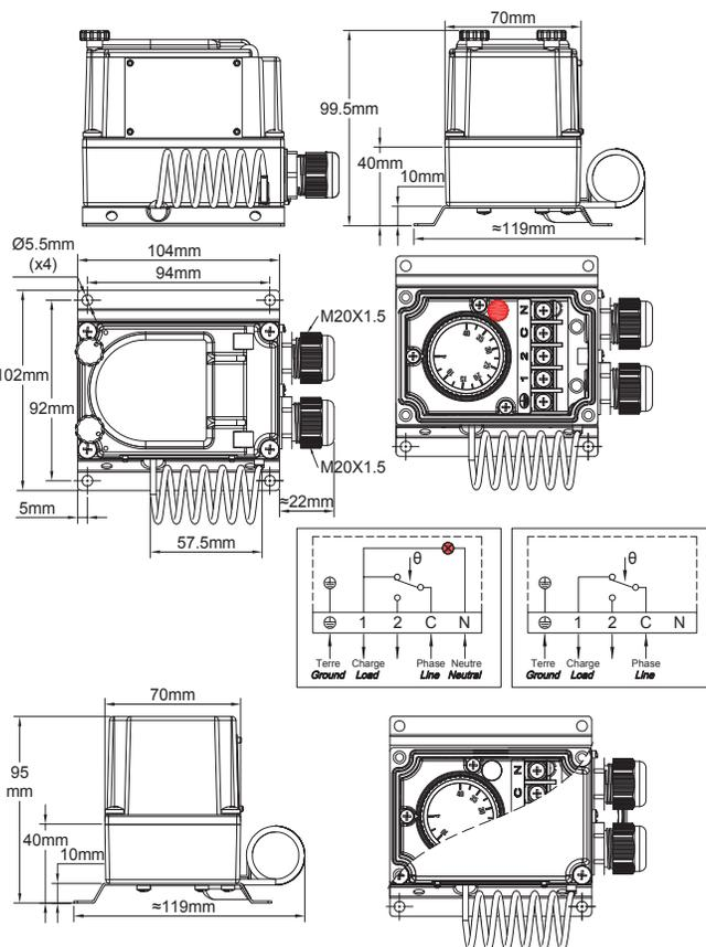
在一个 Y1B2P 的两根伴热电缆的组装示例，与 Y29 接线盒的组合
