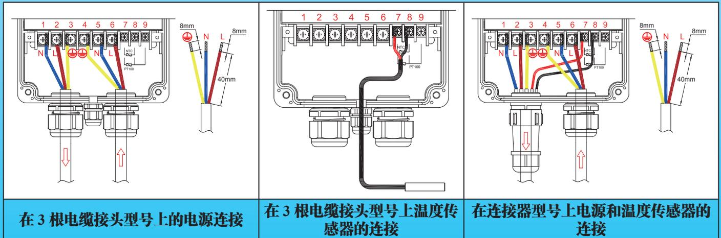
在 3 根电缆接头型号上的电源连接
