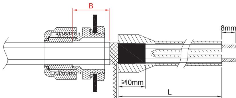
B 的距离应保持最小，以避免机柜内部发热。长度 L 取决于连接端子的距离。
