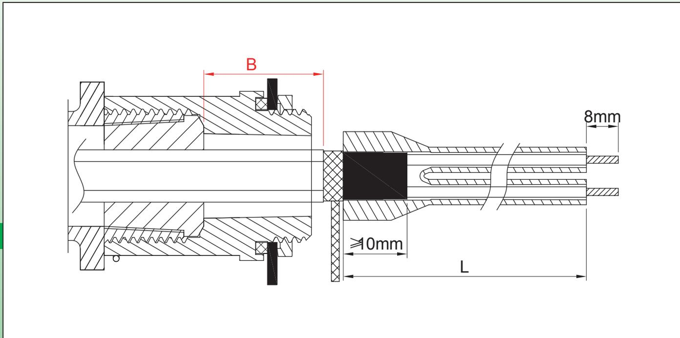
B 的距离应保持最小，以避免机柜内部发热。长度 L 取决于连接端子的距离。
