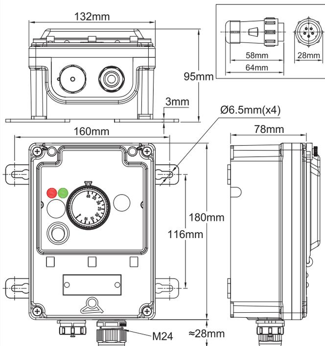
带一个五位连接器和一个 M24 电缆接头的型号:
