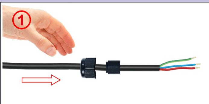
1: 按图纸要求除去圆形电缆的外绝缘层。最后，压接电缆套。将电缆接头螺母滑到电缆上。选择相兼容直径的垫圈并将其滑入电缆。
