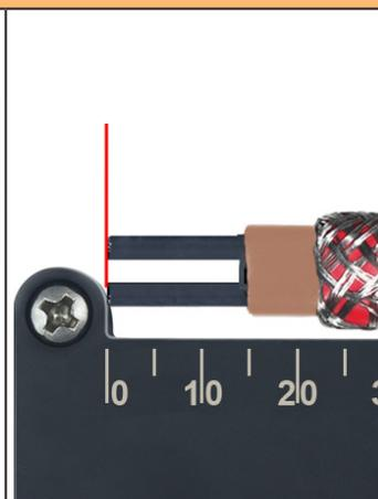
4: 以厘米为单位的刻度，刻印的，在 0cm 处设有机械挡块，以便于测量剥除长度。
