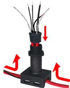
8: 将支脚放置在发热电缆和温度传感器电缆上，从上方将其取出，然后将垫圈滑到电缆上。外部绝缘护套必须从垫圈中伸出。
