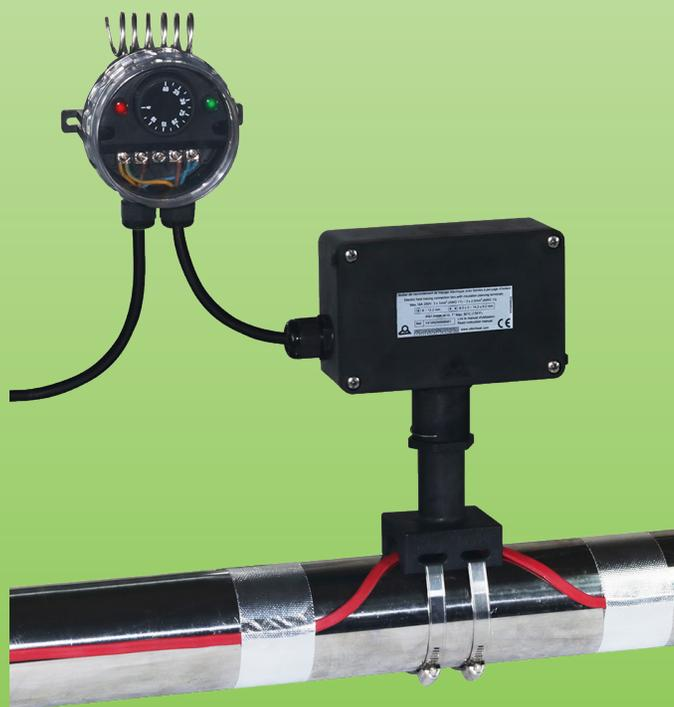
在两根伴热电缆的组装示例，带一个 Y29 接线盒，用于金属管道的防冻保护
