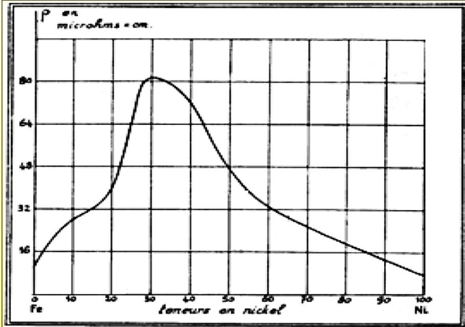
电阻率的变化：铁镍合金中的镍含量曲线图
