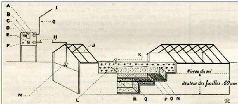
Fig. 1. — Coupe d'une bache chauffée par câbles électriques.
