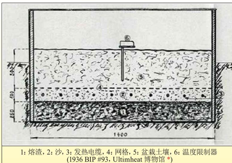
1: 熔渣, 2: 沙, 3: 发热电缆, 4: 网格, 5: 盆栽土壤, 6: 温度限制器
